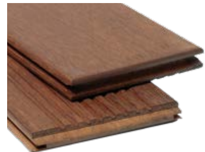
Bambus mineralveredelt , grob genutet/glatt, vorgeölt, stirnseitig Nut & Feder, L 1.850 x B 137 x S 20 mm
