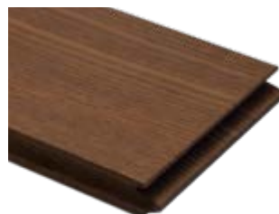
Thermo-Esche, Kopfseiten Nut und Feder, seitliche Rund- hohlkehle (für TENI- Clip), L 1.500/1.800/2.100 x B 130 x S 20 mm
