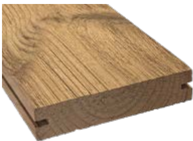
Thermo Kiefer , gebürstet/glatt, längsseitige Nut, L 3.000/3.300/3.600/3.900/4.200/4.500/ 4.800/5.100 x B 115 x S 26 mm
