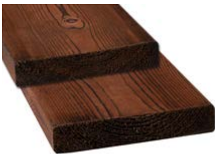
Kiefer braun , massiv, imprägniert und mit Leinöl behandelt, glatt/glatt, L 3.000/3.900/4.500/4.800 x B 145 x S 28 mm
