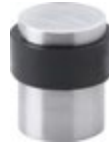
Türstopper Fermare Edelstahl matt, ø 30/35 mm, Höhe 39 mm, mit Holz- schraube 6 x 60 mm, Dübel ø 10 mm
